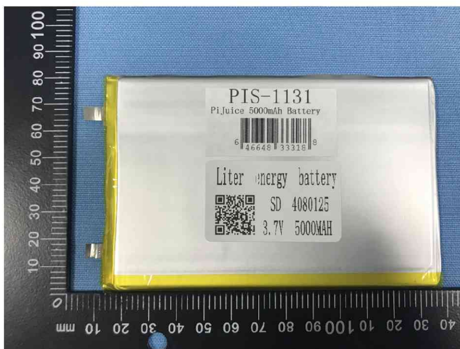
Photo 3 Internal Cell 内部电芯
